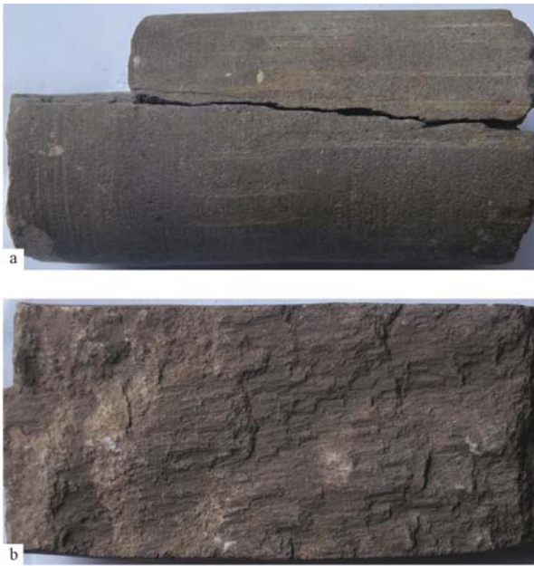
图1 南襄盆地安棚油田储层岩心上的构造剪切裂缝
